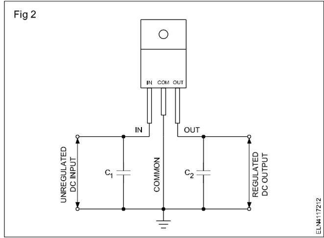
कैपेसिटर  $C_2$  का उपयोग रेगुलेटर आउटपुट वोल्टेज के परिवर्तनशील व्यवहार को सुधारने के लिए किया जाता है। कैपेसिटर  $C_2$  इन परिवर्तनशील उत्पादों को ऑन/ऑफ की अवधि में बाईपास कर देता है। कैपेसिटर  $C_2$  का मान सीमा  $0.1\mu\text{F}$  से  $10\mu\text{F}$  तक होती है।
